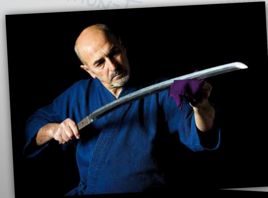
Dopo l'analisi della spada passare un'ulteriore volta il *nugui gami* e stendere poi su tutta la superficie un leggero strato di olio di garofano *Choji Abura*
